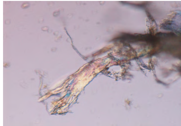
Ramie Fasern unter polarisierendem Licht, die aus chinesischem Lumpenpapier stammen und daher stärker fibrilliert und beschädigt sind als ein aus originalen Pflanzenteilen gefertigtes Papier.
