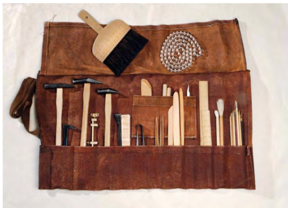
Sydney Thomsons Handwerksbeutel mit Restaurierungswerkzeugen, darunter eine Kette aus Glaskugeln zum Glätten und Glänzendreiben des Papiers sowie verschiedene Hammer zum Anbringen von Metallverstärkungen
